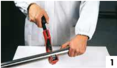
1 Mise à longueur des tubes
