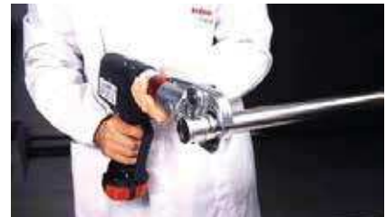
6 Réalisation du sertissage
