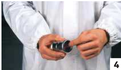
4 Vérification du joint d'étanchéité
